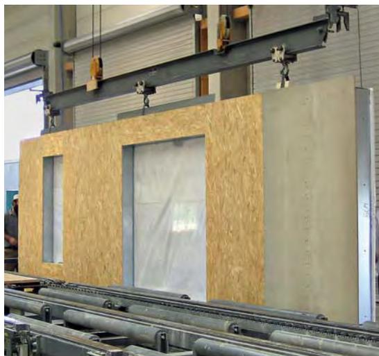
Links: Befestigung der aussteifenden Beplankung mit ballistischen Nägeln
