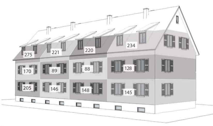
Abbildung 7.7 Jahresheizwärmebedarf des Bestandes in kWh/m²a
